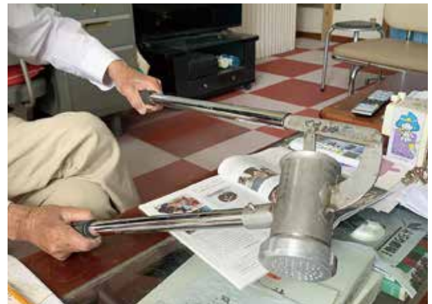
イモキリを大量生産するための押し出し器具
