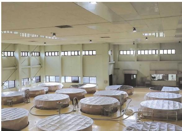
醸造タンク(微生物を使って発酵させる)
