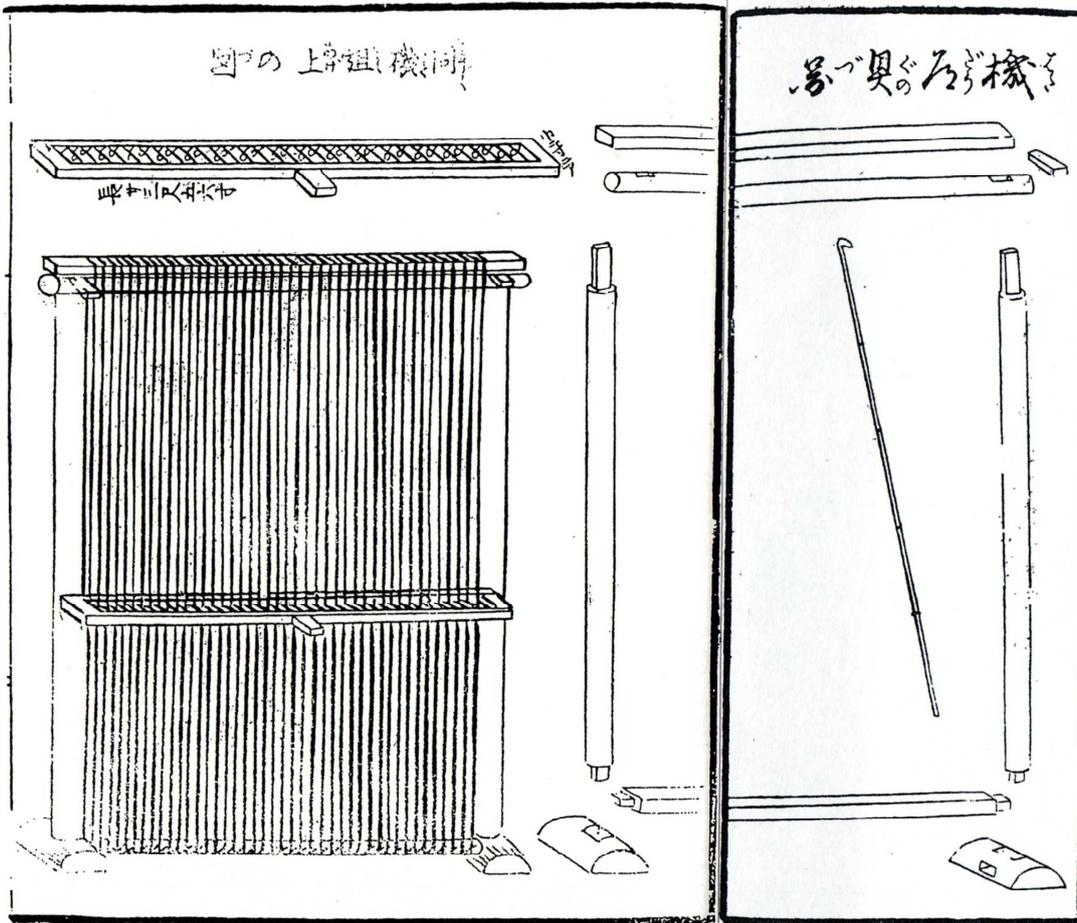
図7 機道具図・同機組上の図
